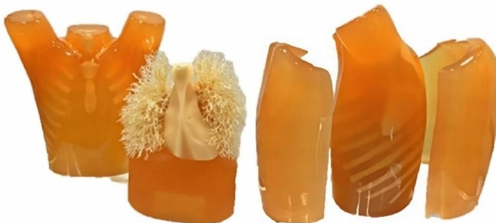
Рисунок 5 – Фотография используемого антропоморфного модельного объекта PH-1 Multipurpose Chest Phantom N1 (Kyotokagaku, Япония) со специальными утолщающими пластинами.
